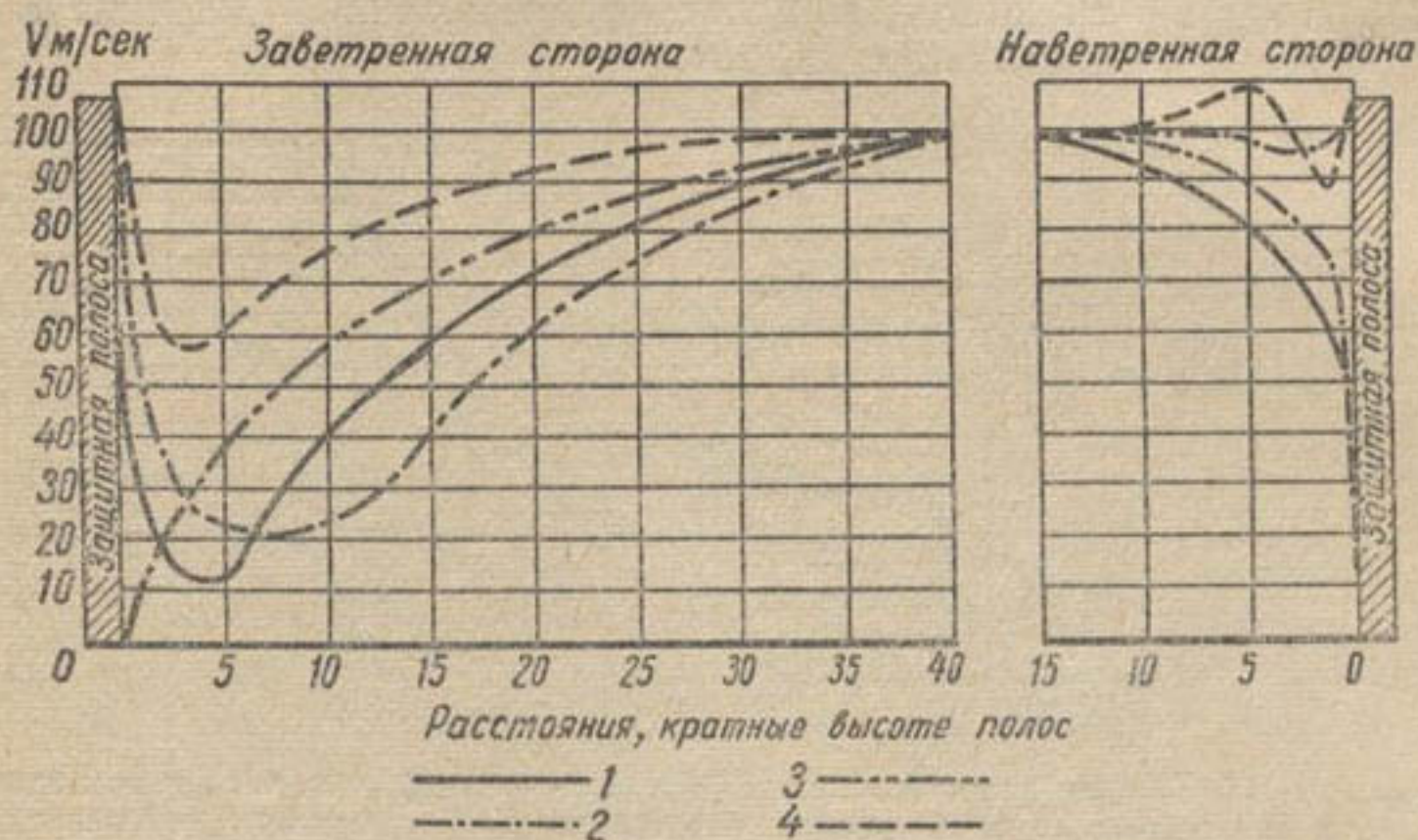
Рис. 40. Изменение скорости ветра на высоте 100 см, под влиянием поперечных лесных полос (в % от скорости ветра на открытом месте):
