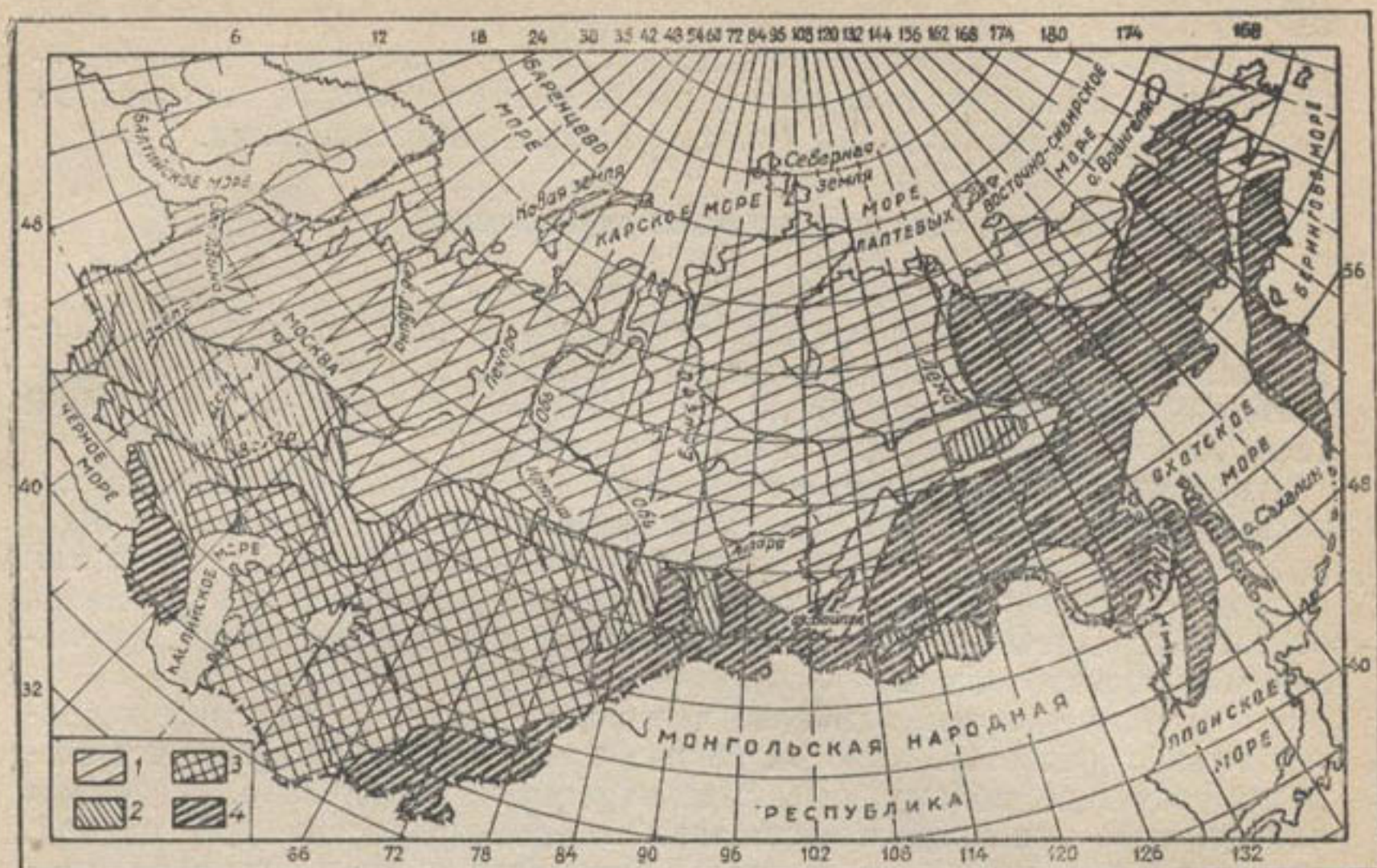
● Рис. 99. Поправки к карте среднемноголетних модулей рек СССР, л/сек·км 2 :
