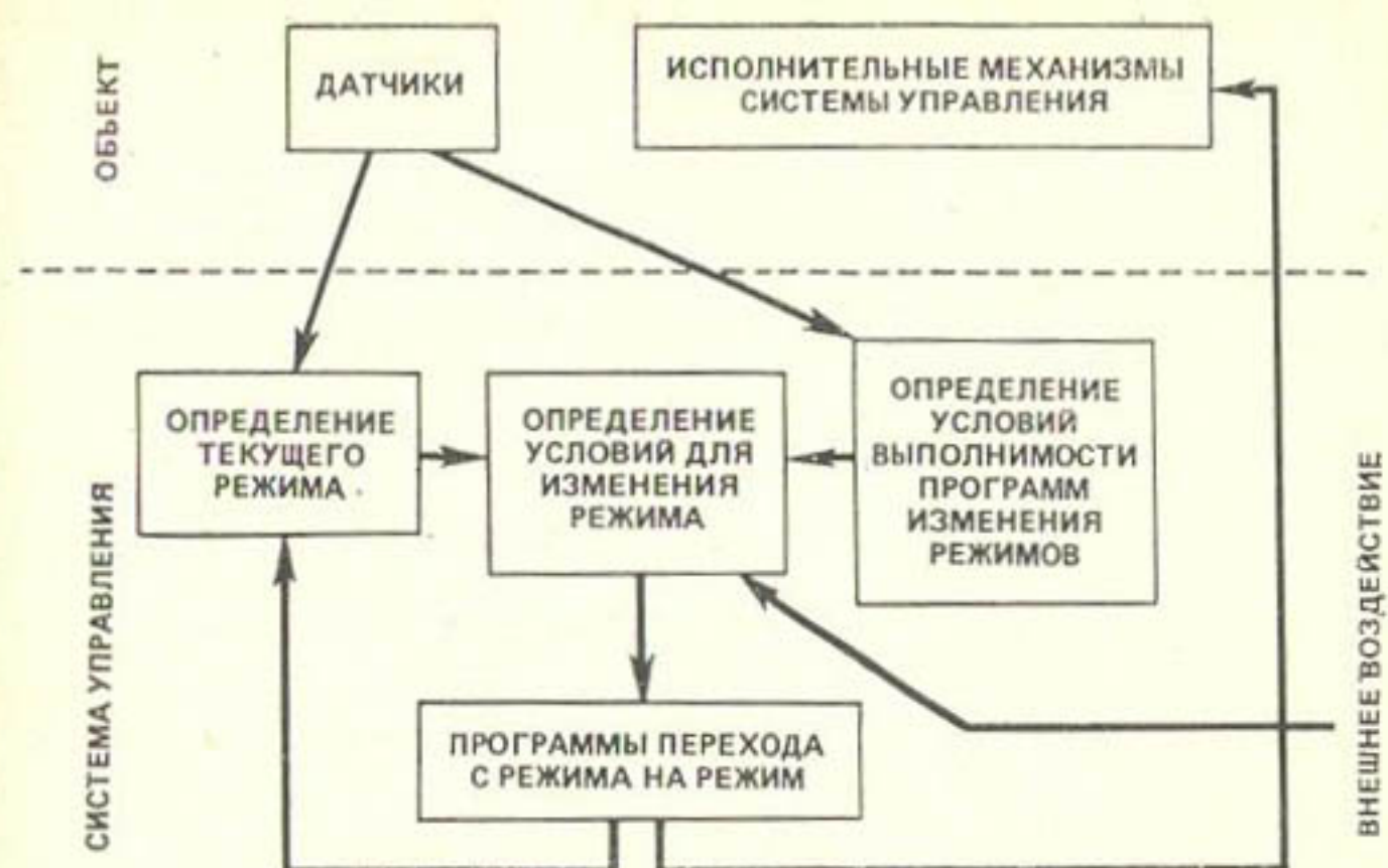
Рис. 1. Укрупненная диаграмма работы системы управления водным режимом корнеобитаемого слоя почвы.
