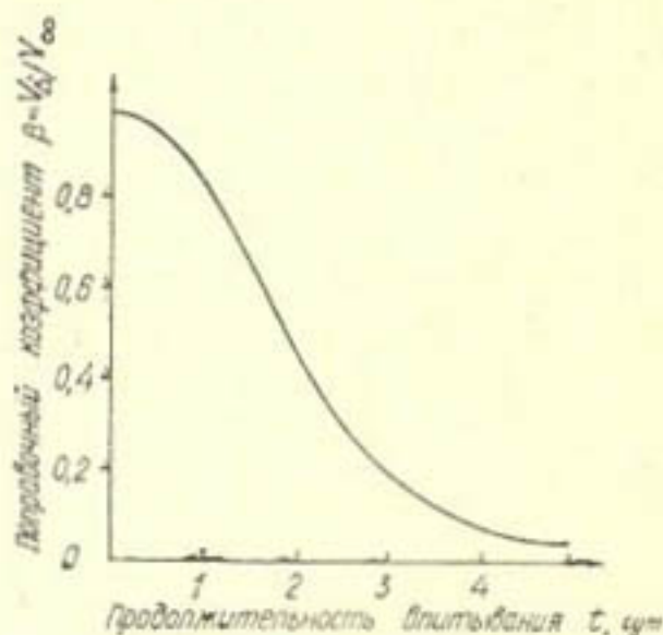
Рис. 9. График изменения поправочного коэффициента \beta = V_\Delta / V_\infty в формуле (18) в зависимости от глубины грунтовых вод \Delta .
