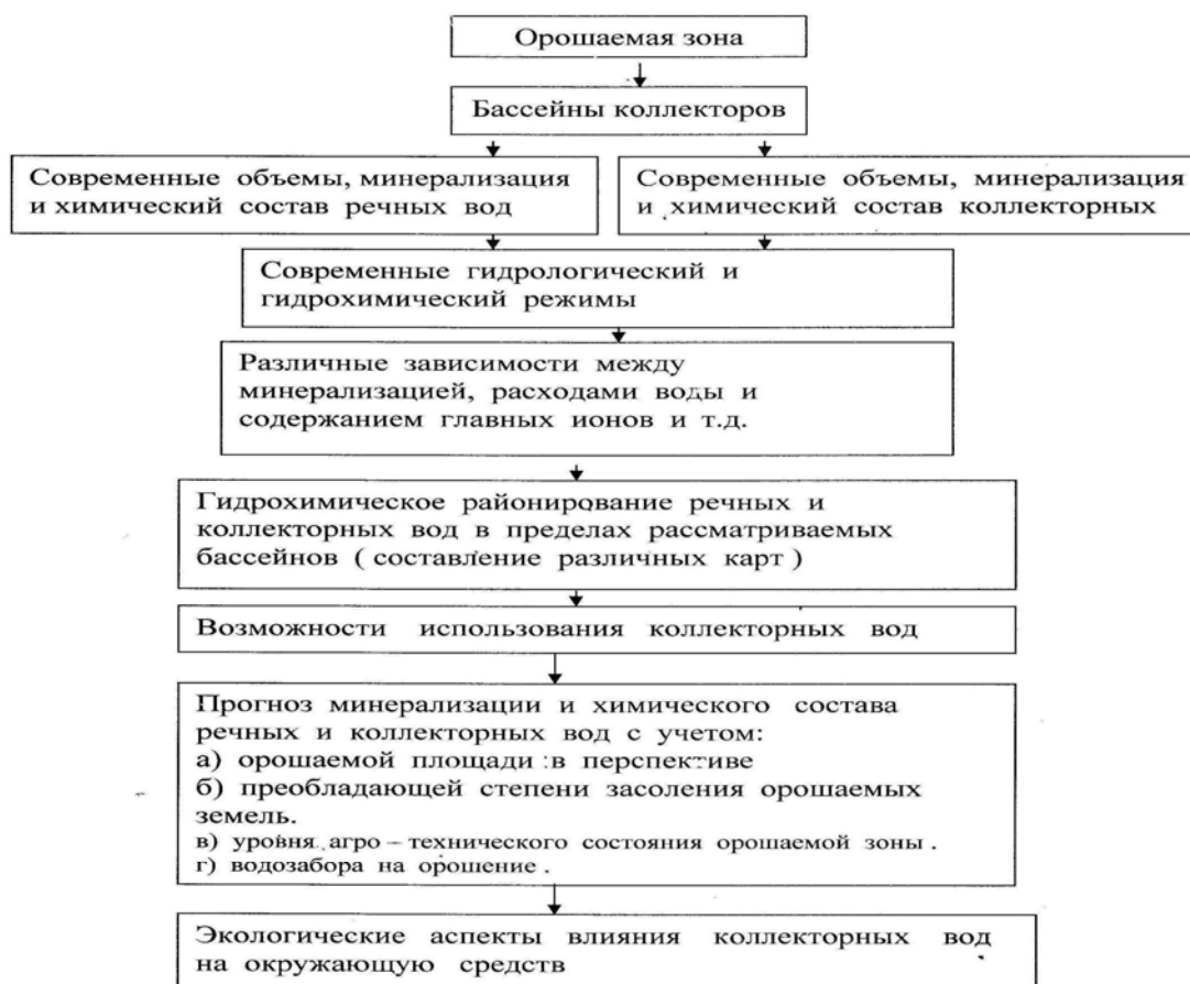
Рис.2.6- Основные позиции бассейнового ландшафтно-галогеохимического метода изучения динамики минерализации и химического состава речных и коллекторно-дренажных вод
