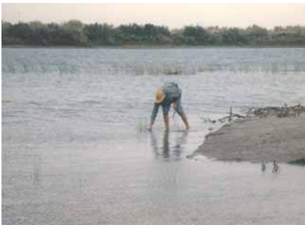
Отбор интегральной пробы перифитона в озерной литорали с подводной части стеблей тростника
