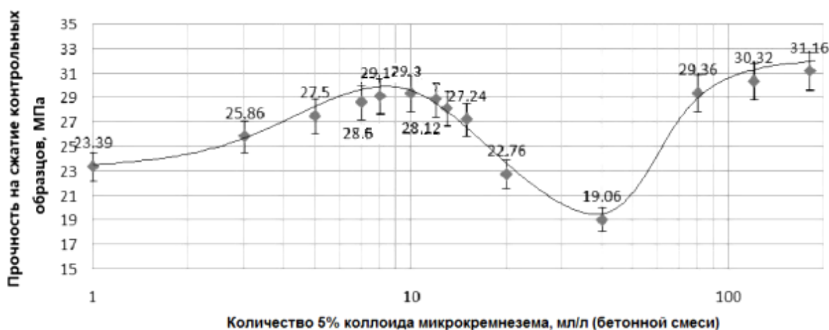
Рис. 4 - Влияние микроколичеств высокодиспергированного микрокремнезема на прочность при сжатии контрольных образцов мелкозернистого бетона при В/Ц=0,4 (без пластифицирующих добавок)
