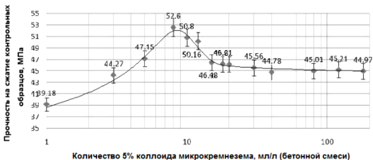
Рис. 5 - Влияние микроколичеств высокодиспергированного микрокремнезема на прочность контрольных образцов модифицированного мелкозернистого бетона при В/Ц=0.25 с пластификатором MF5581 (0.4% от ПЦ)
