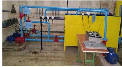
**11-расм. ГАЭС экспериментал стени схемаси (а) ва кўриниши (б)**
