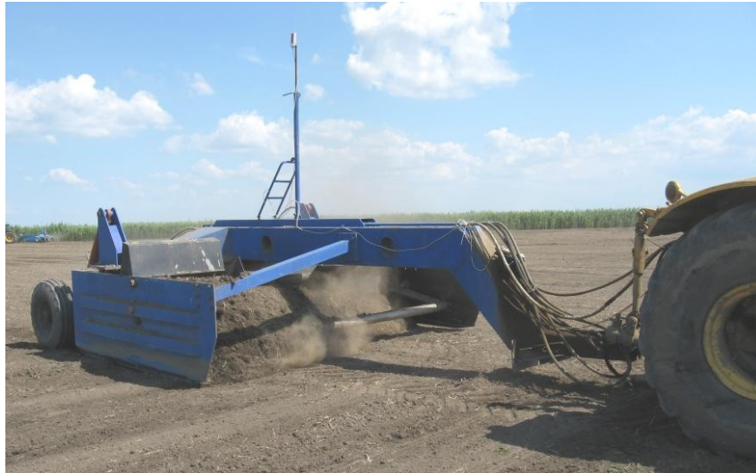
Рис. 3.4 Короткобазовый скрепер-планировщик СП-4,2 с лазерным управлением
