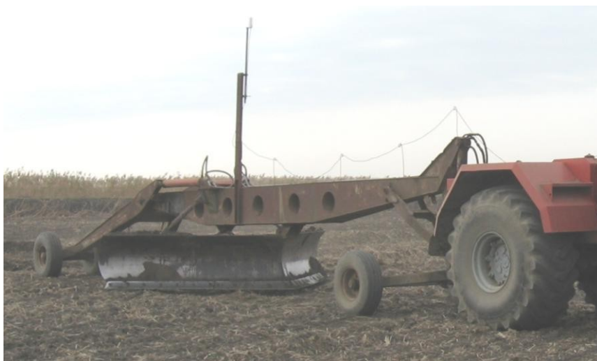
Рис. 3.3 Прицепной клин-планировщик КП-719 с лазерным управлением
