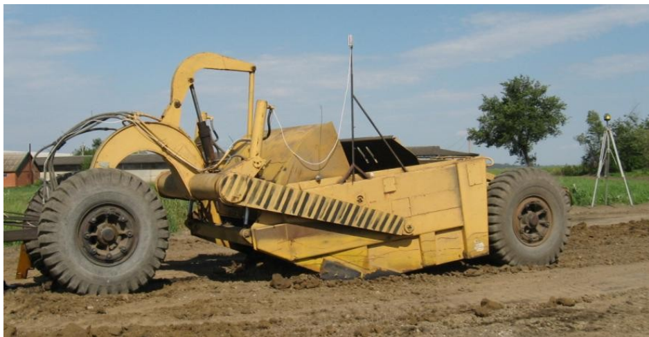
Рис. 3.1 Прицепной скрепер ДЗ-77 с лазерным управлением
