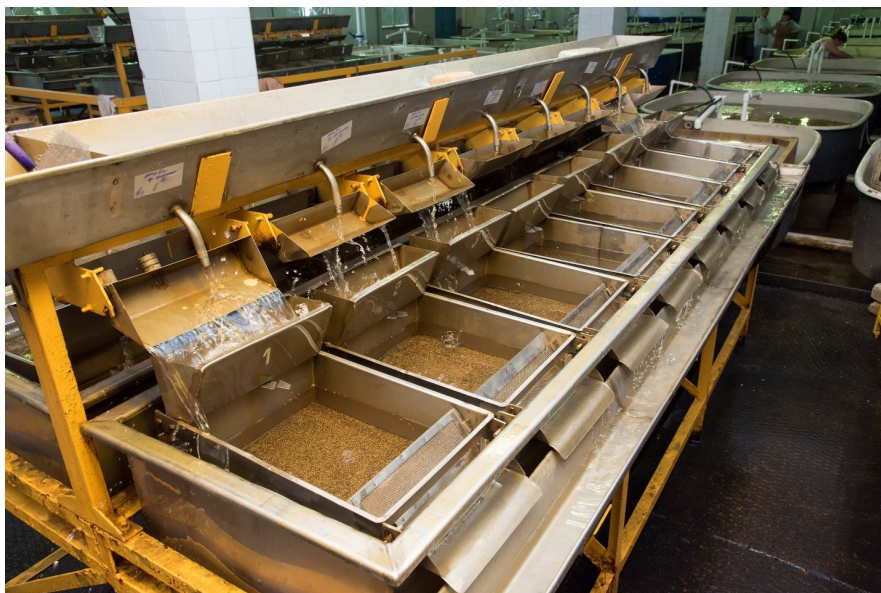
Фото 28. Инкубация икры русского осетра в инкубационном аппарате «осетр». (Волгоградский осетровый рыболовный завод). (Фото Сытилин П.В.)
