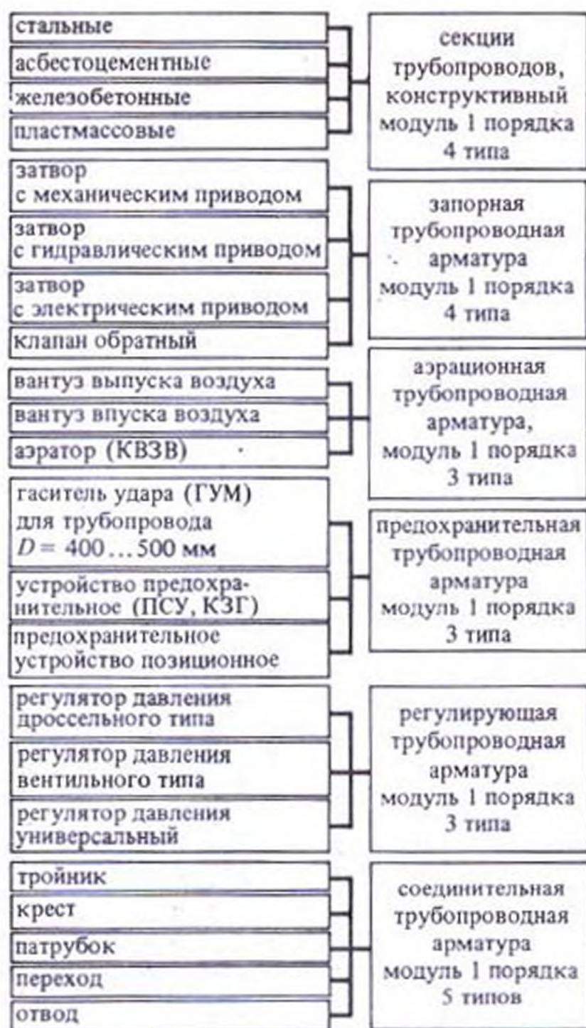
Рис. 5.1. Блок-схема формирования конструктивных модулей
