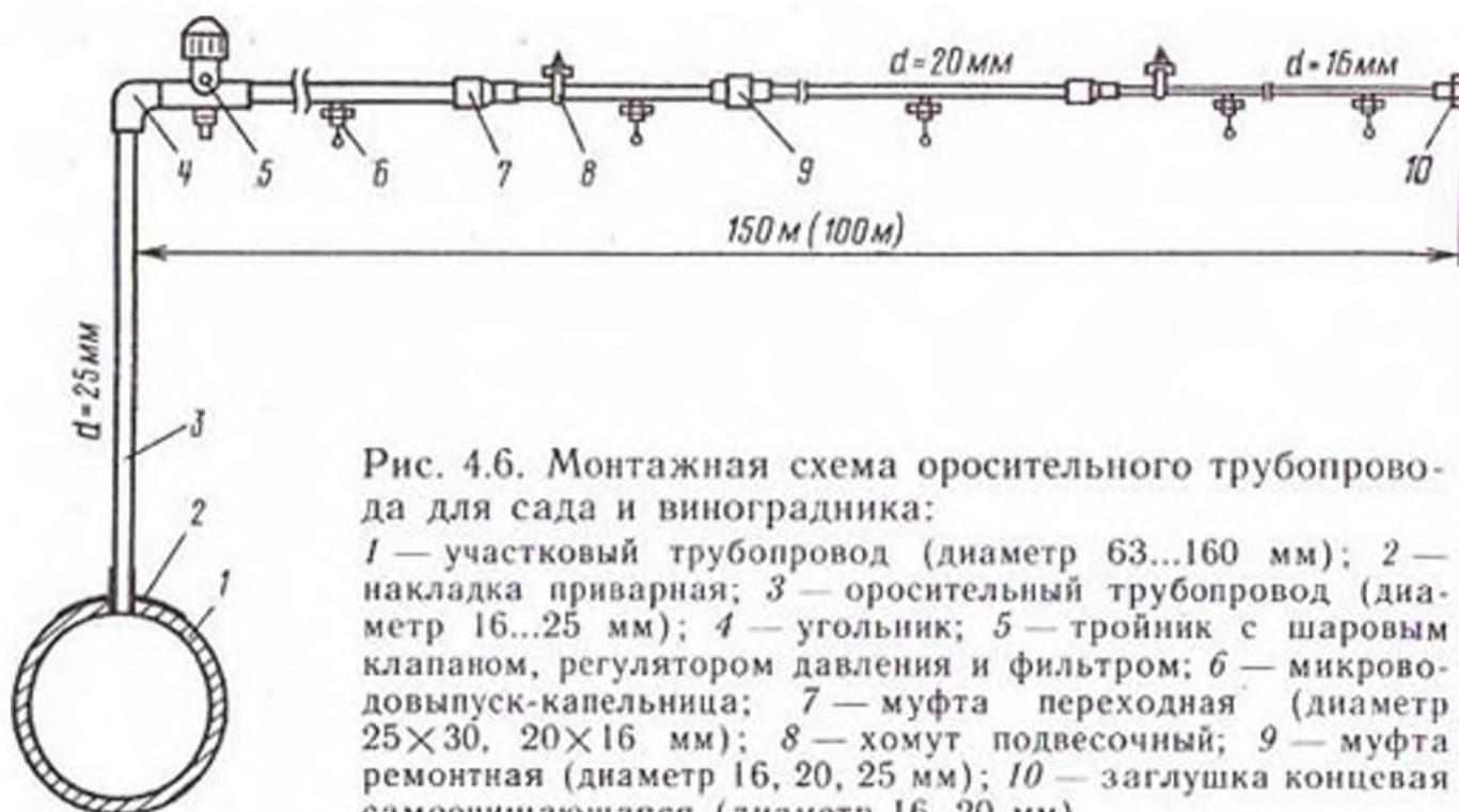
Рис. 4.6. Монтажная схема оросительного трубопровода для сада и виноградника:
