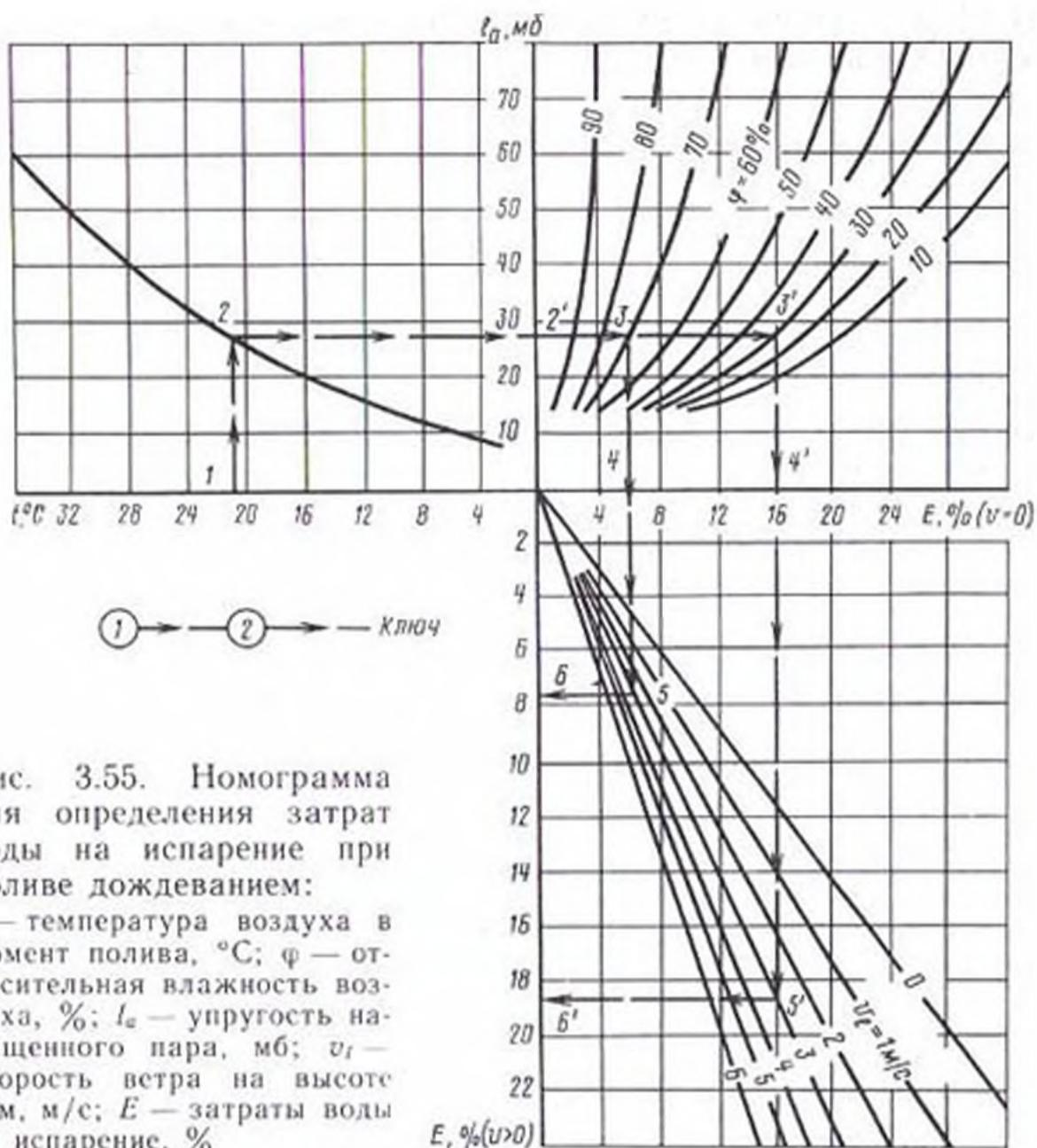
Рис. 3.55. Номограмма для определения затрат воды на испарение при поливе дождеванием:  $t$  — температура воздуха в момент полива,  $^\circ\text{C}$ ;  $\phi$  — относительная влажность воздуха, %;  $i_a$  — упругость насыщенного пара, мб;  $v_t$  — скорость ветра на высоте 2 м, м/с;  $E$  — затраты воды на испарение, %
