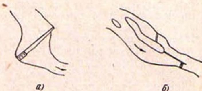
Рис. 52. Расположение сооружений, при которых могут иметь место ледовые затруднения.
