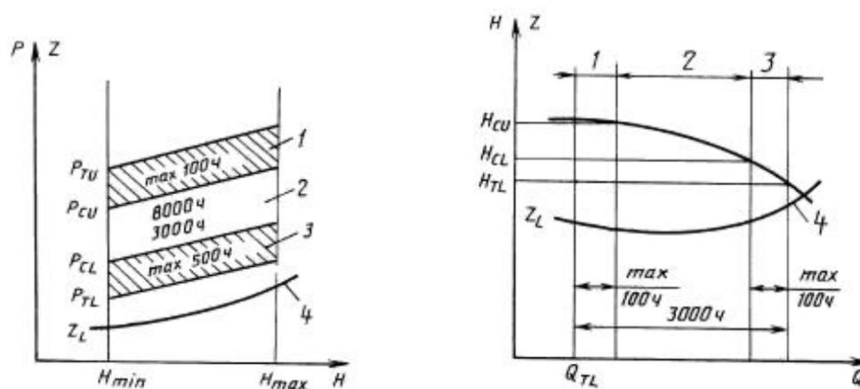
1 — диапазон режимов кратковременной работы гидротурбины при повышенной нагрузке; 2 — диапазон режимов продолжительной работы; 3 — диапазон режимов кратковременной работы гидротурбины при пониженной нагрузке; 4 — минимальный допустимый уровень нижнего бьефа
