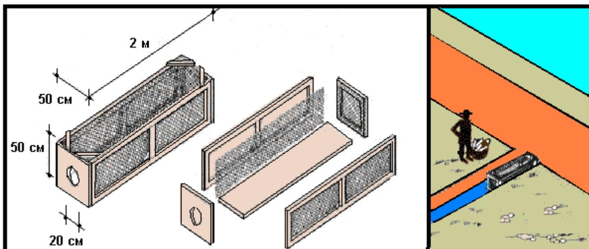
Рис. 21. Схема переносного рыбоуловителя и его установки.
