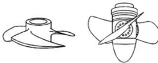
Рис. 4. Пропеллерная турбина с фиксированными лопастями и Поворотно - лопастная турбина
