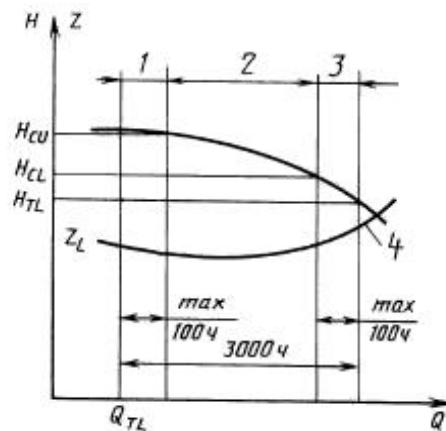
1 — диапазон режимов кратковременной работы насоса при повышенном напоре; 2 — диапазон режимов продолжительной работы насоса; 3 — диапазон кратковременной работы насоса при пониженном напоре; 4 — минимальный допустимый уровень бьефа на всасывании
