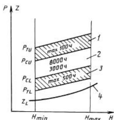
1 — диапазон режимов кратковременной работы гидротурбины при повышенной нагрузке; 2 — диапазон режимов продолжительной работы насоса; 3 — диапазон режимов кратковременной работы гидротурбины при пониженной нагрузке; 4 — минимальный допустимый уровень бьефа на всасывании
