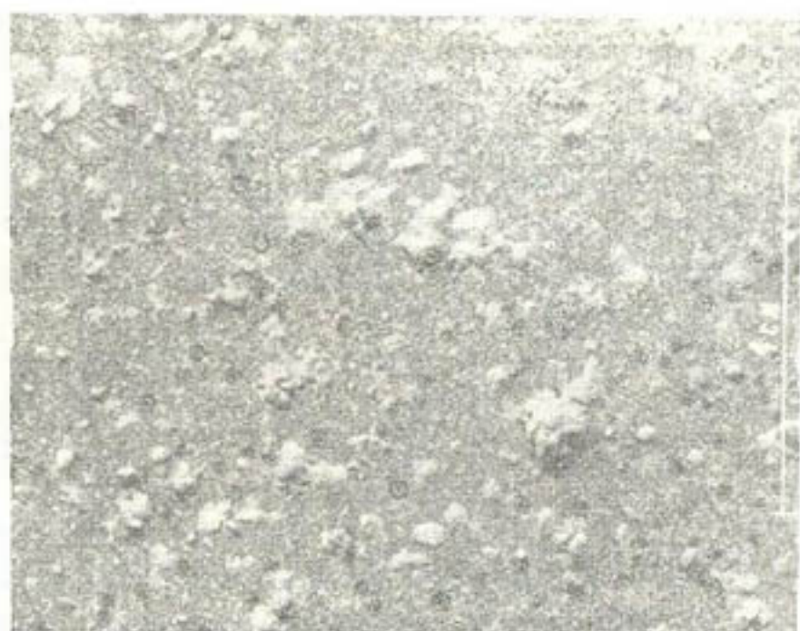
Рис. 26. Фотография частиц и комков суглинка, вымытых из щели при градиенте напора, равном 6,2. Увеличено в 3,5 раза.
