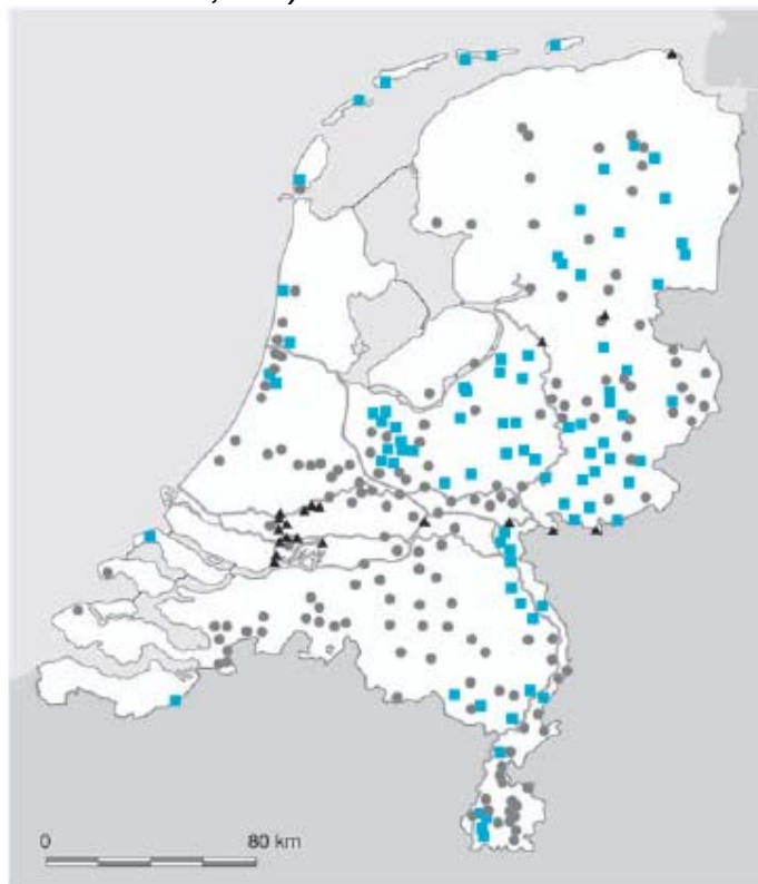
Рисунок 10.3.2 Расположение мест добычи подземных вод для коммунального водоснабжения в Нидерландах, классифицированных по типам добычи (Источник: RIVM, 1992)
