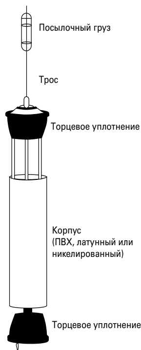
Рисунок 1.7.5. Пробоотборник Кеммерера
