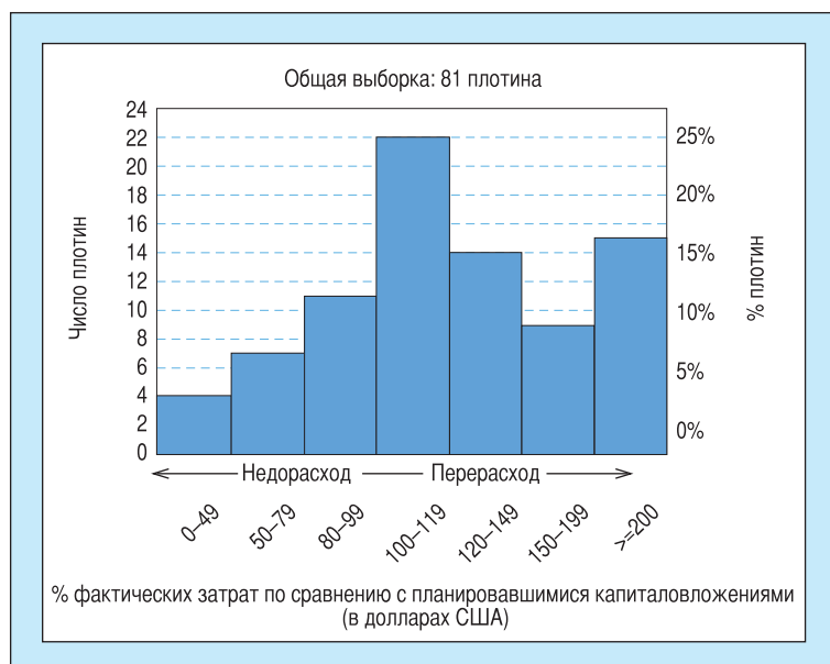
Рис. 2.1 Перерасход средств при строительстве крупных плотин
