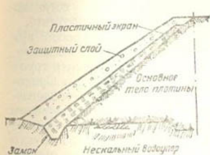
Рис. 38. Пластичный экран плотины на мягком водоупорном основании
