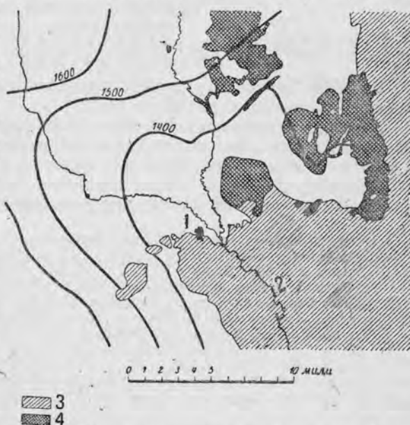
Рис. 89. План в гидроизогипсах грунтовой воды в артезианском бассейне Южной Дакоты (по Тодду и Голлу). 1 — Митшель; 2 — Джекс-Ривер; 3 — район с зеркалом грунтовых вод, лежащим под поверхностью земли; 4 — район с самозаливающимися артезианскими водами.
