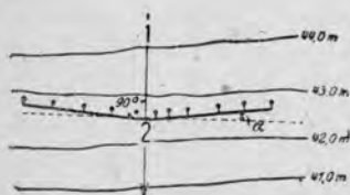
Рис. 203. Схематическое расположение каптажа с двумя отводами, отклоняющегося вверх по течению.
