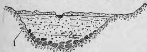
Рис. 21. Разрез водоносного пласта с выстланной каменной постелью.
