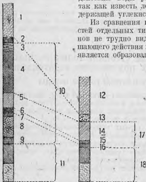
Рис. 146. Схематическое изображение водоносной брекчии, возникшей вследствие выщелачивания провала (по Грюне).
