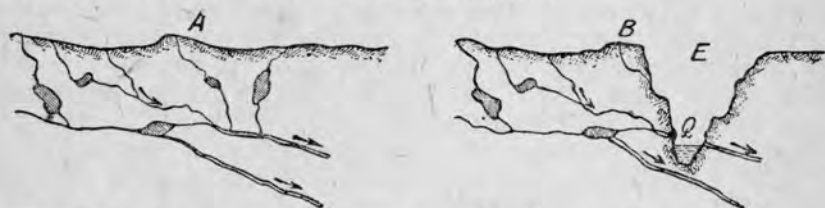
Рис. 7. Схематическое изображение источника, питаемого подземным водотоком.
