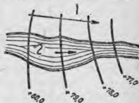
Рис. 76. План в гидроизогипсах грунтовой воды указывает, что поверхностные воды и грунтовая вода независимы друг от друга.
