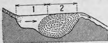
Рис. 166. Задержка красящего вещества в углублениях поперечного разреза.
