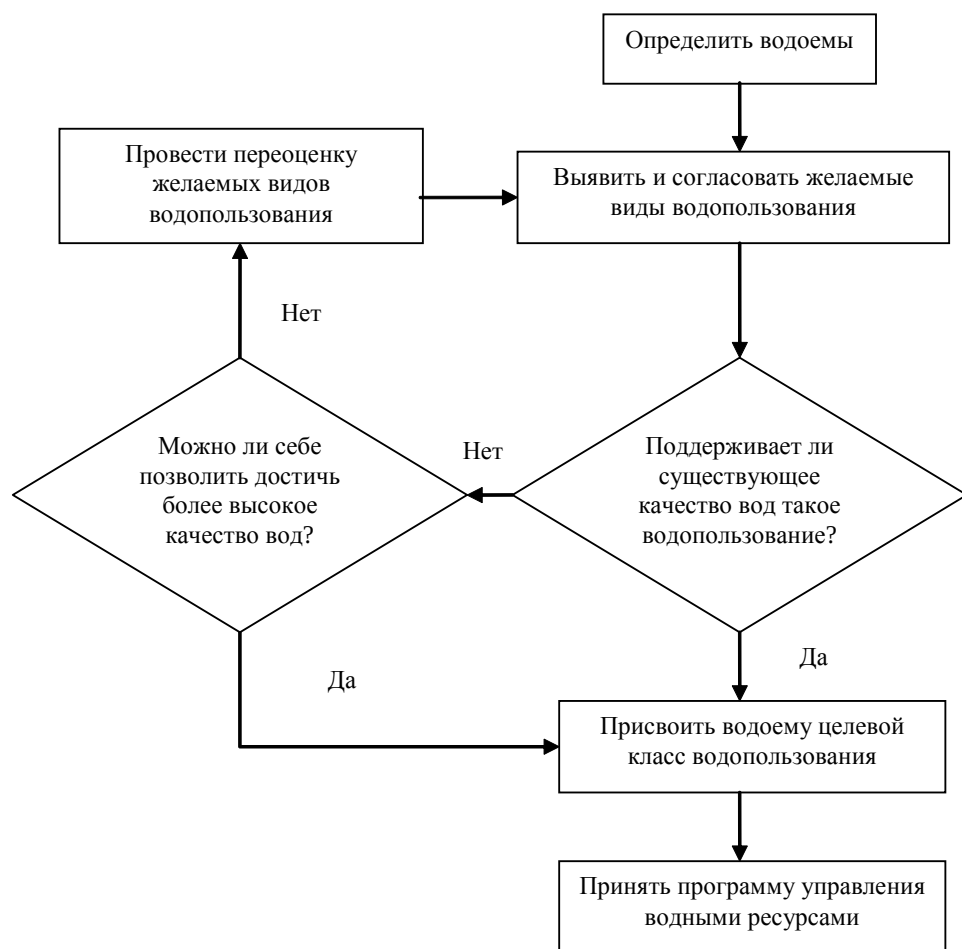
Рисунок 1. Пример итеративного процесса планирования качества вод
