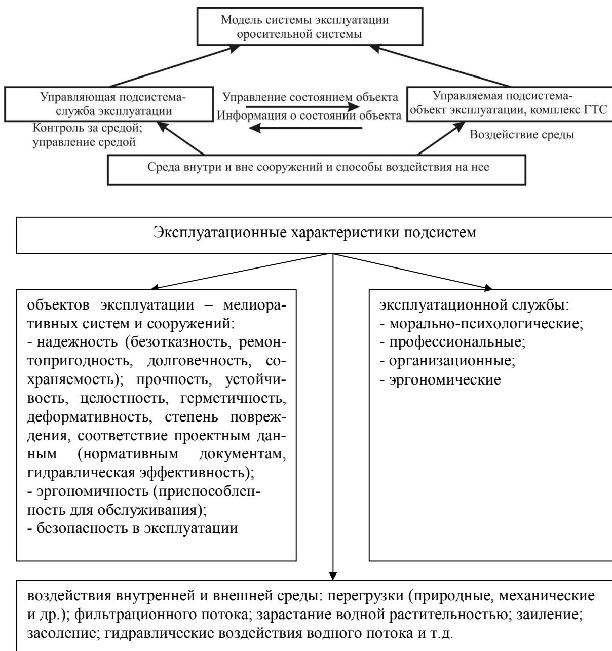
Рисунок 6 – Модель системы эксплуатации и их эксплуатационные характеристики
