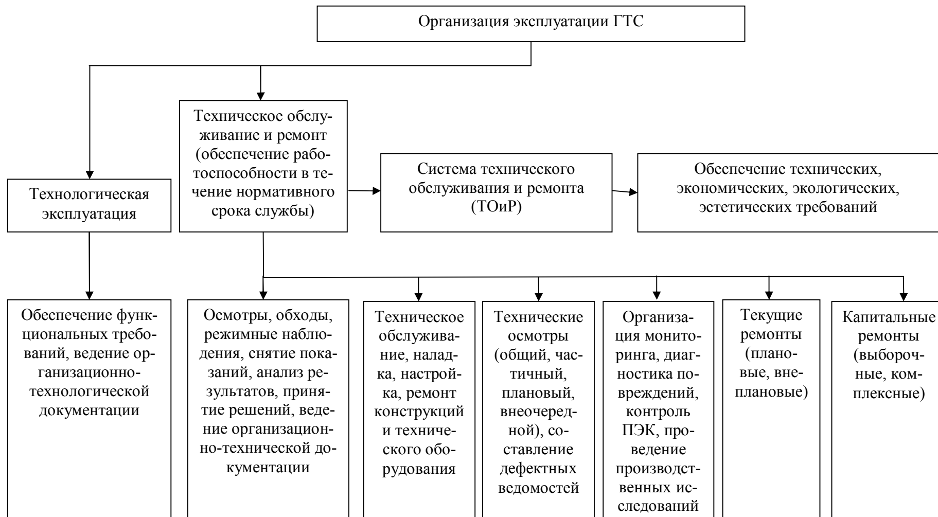
Рисунок 2 – Схема организации эксплуатации ГТС мелиоративного назначения
