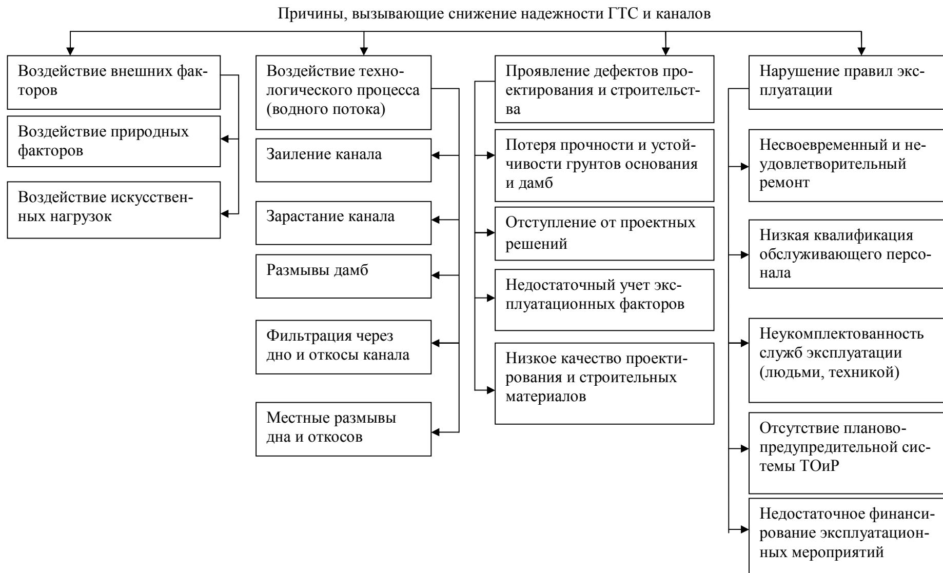
Рисунок 8 – Причины, вызывающие снижение надежности ГТС и каналов
