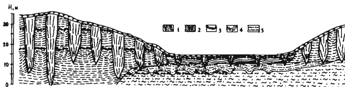
Рис.8.2. Схема строения ледового комплекса на о.Б.Ляховском, по Н.Н.Романовскому. 1 - повторножильные льды в супесчано-суглинистых отложениях основной поверхности едомы, 2 - повторножильные льды в суглинистых отложениях аласа, 3 - погребенные оторфованные почвенные горизонты, 4 - термокарстовые отложения, выполняющие псевдоморфозы по повторножильным льдам, 5 - отложения,вещающие псевдоморфозы
