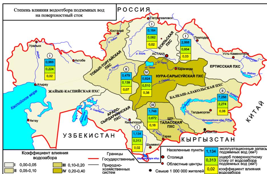
Рисунок 5 – Влияние водоотбора подземных вод на поверхностный сток
