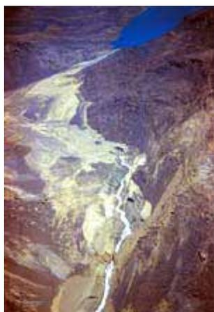
Фото.4. Вид на каньон в нижнем бьефе завальной плотины. Его длина 2 км. Кратчайшее расстояние между первым родником в головной части каньона и Сарезским озером - 1800 м. Видны селевые отложения северной части Усойского завала. Вот здесь и будет прорыв вод Сарезского озера через завальную плотину. Снимок сделан с вертолета. Высота 4500 м. Папырин Л.П., 1976 год.
