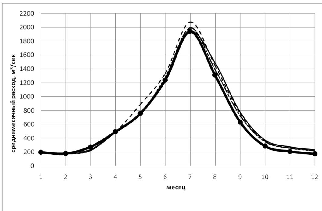
Рис. 6. Расчет гидрографа 90-% обеспеченности 1932 г.
