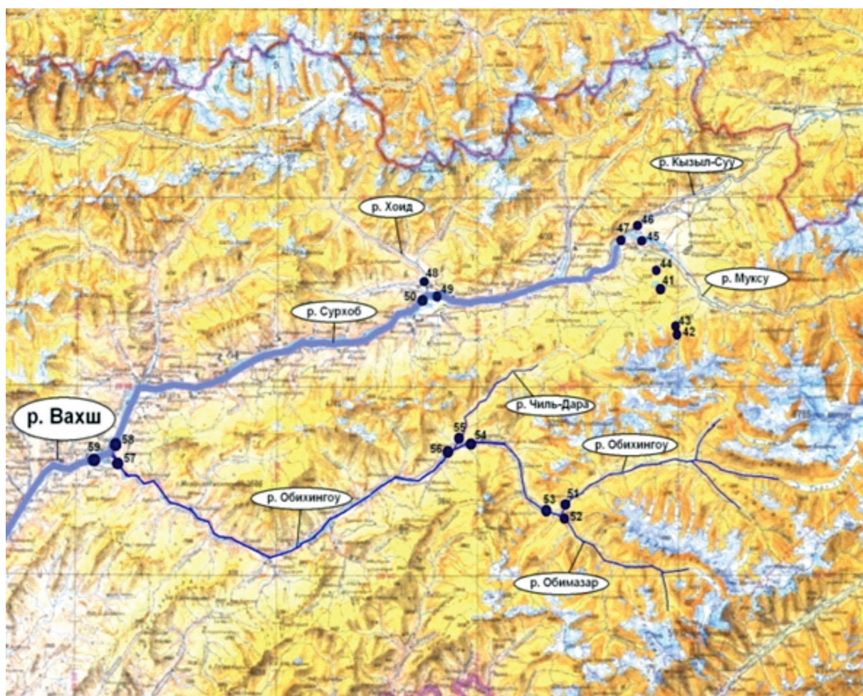
Рис.2 Схема формирования стока бассейна р. Вахи с основными местами опробования вод на изотопный состав урана
