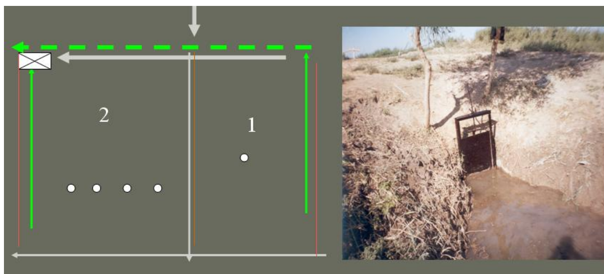
Рис 2.1 Схема опытно-производственного участка. Перегораживающее сооружение в конце первичной дрены.
