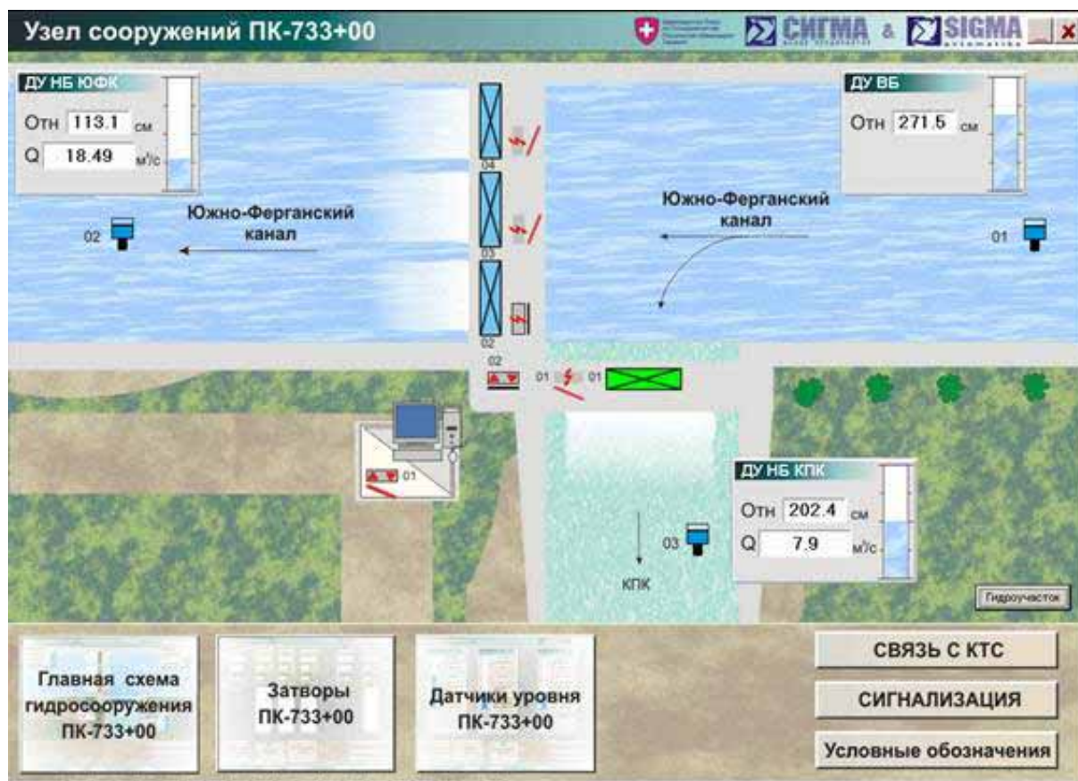
Рис. 14. Сооружение Хамза, главная мнемосхема системы SCADA
