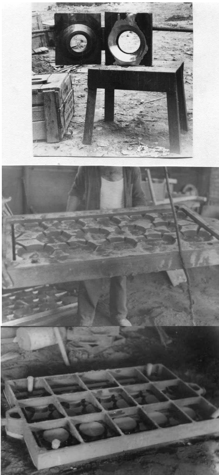
Рис. 3.9. Изготовление оснастки для отливки профильных поддонов на Янгиерском заводе
