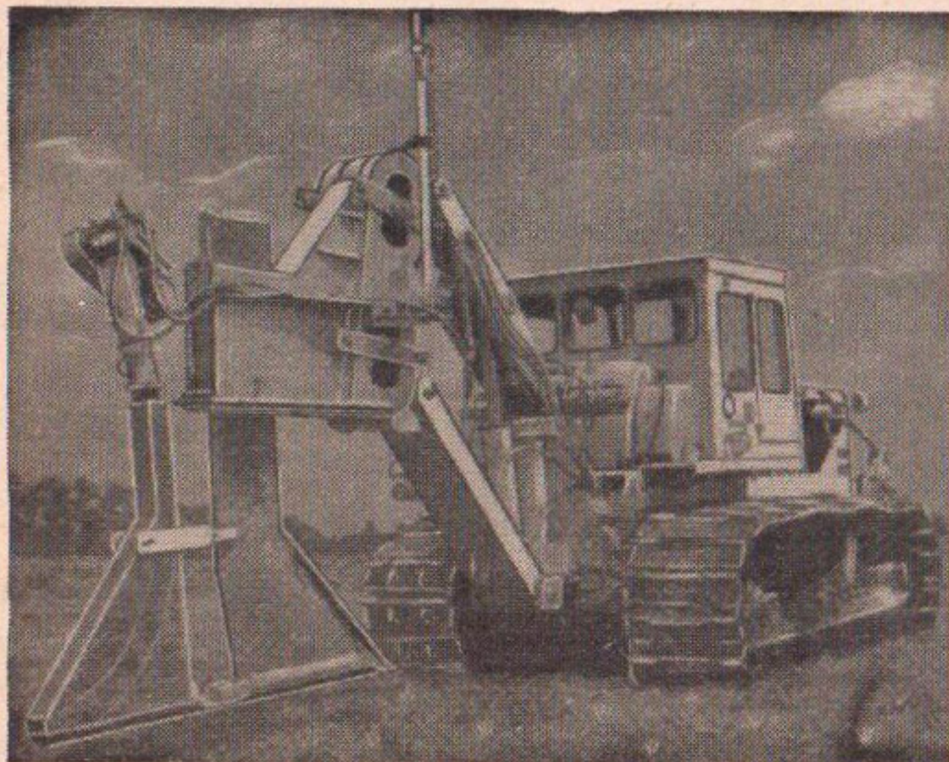
Рис. 5. Дреноукладчик "Баджер Майнер" (Англия)
