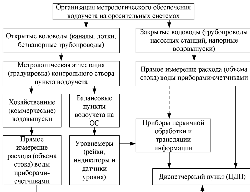
Рисунок 24 – Структурная схема организации метрологического обеспечения водоучета на объектах ОС
