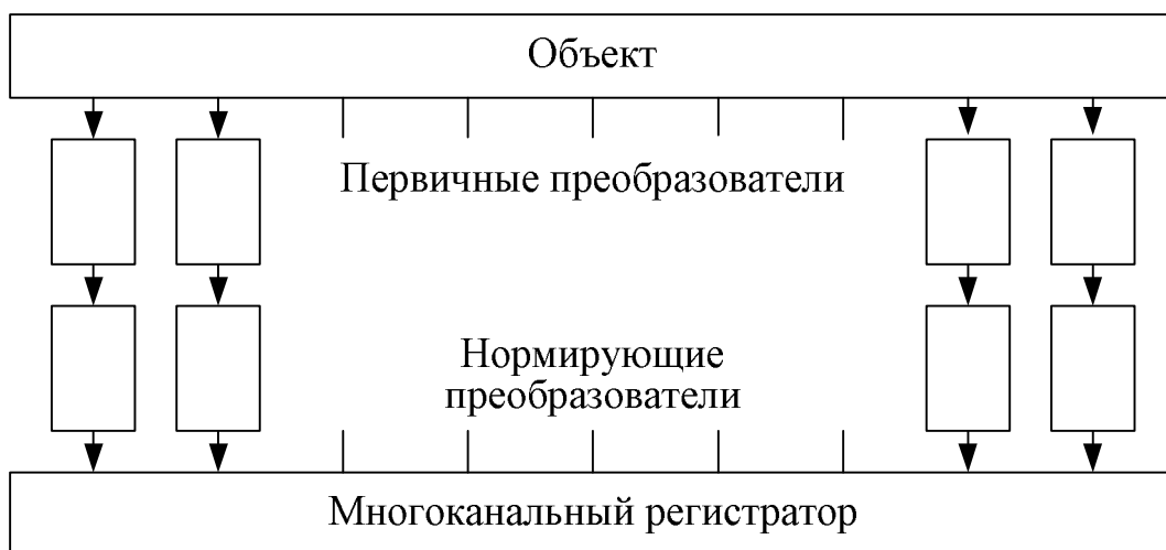
Рисунок 29 – Структурная схема многоканальной измерительной системы
