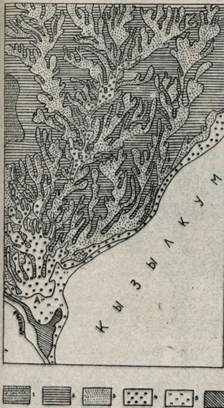
Рис. 1. Карта глубины залегания (м) грунтовых вод верхней части Кызкеткен-Чимбайской дельты: 1 - 0-1, 2 - 1-2, 3 - 2-3, 4 - 3-4, 5 - 4-5, 6 - 5-10.
