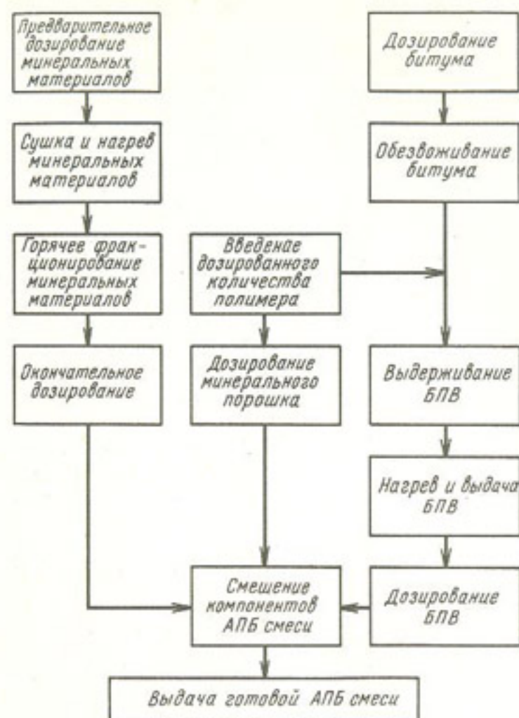
Рис. 31. Технологическая схема приготовления асфальтополимербетонной смеси
