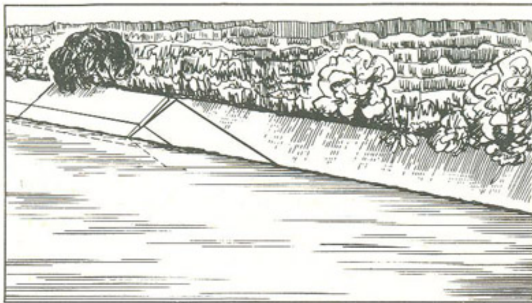
Рис. 44. Сползание плит НПК с полиэтиленовым экраном из-за попадания ливневой воды
