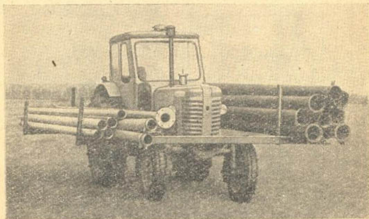
Рис. 8. Пропашной трактор, оборудованный для перевозки труб.
