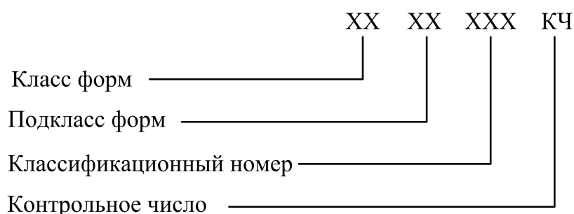
Рисунок 6 – Структура кодового обозначения унифицированной формы документа по ОКУД
