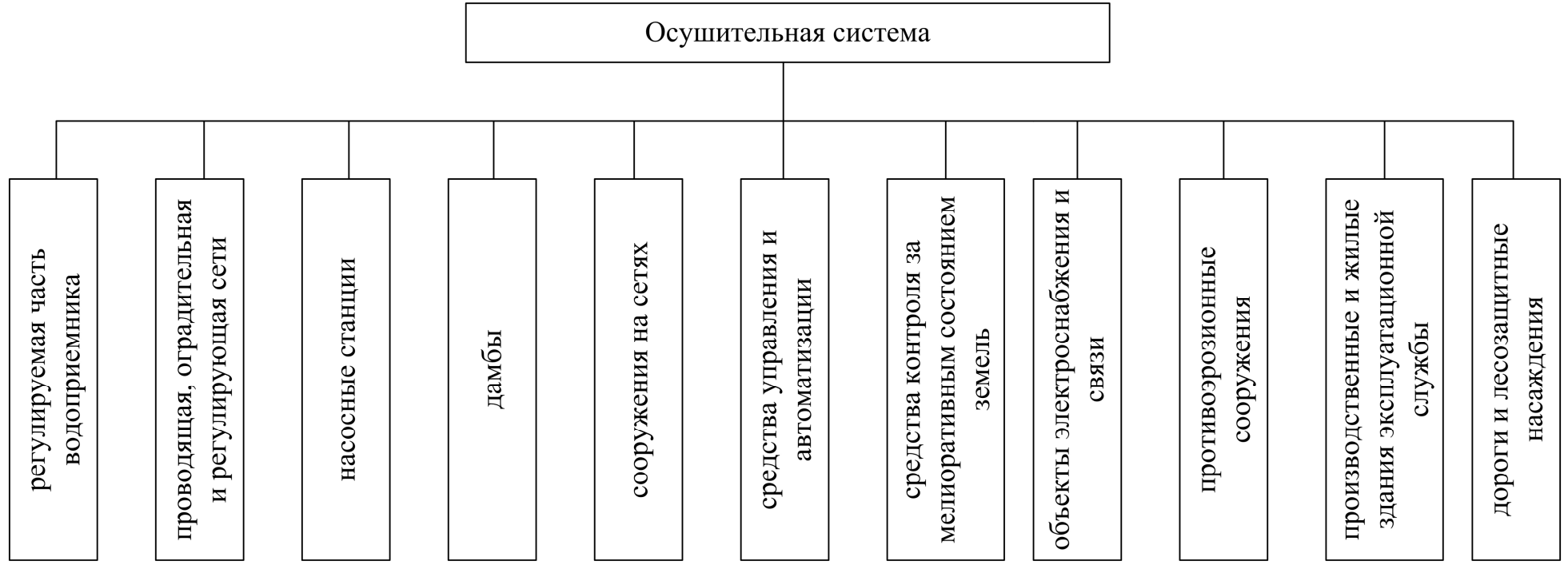
Рисунок 17 – Состав осушительной системы согласно СНиП 2.06.03-85
