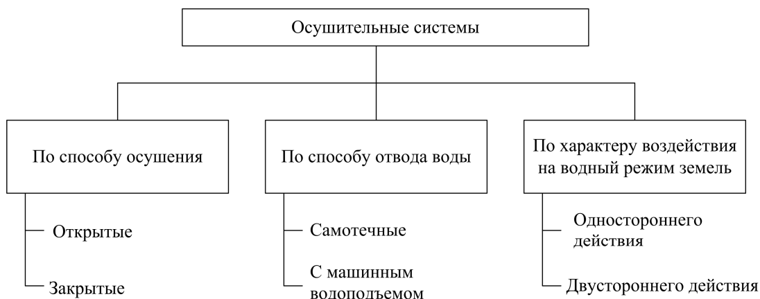
Рисунок 22 – Классификация осушительных систем согласно Мелиоративной энциклопедии
