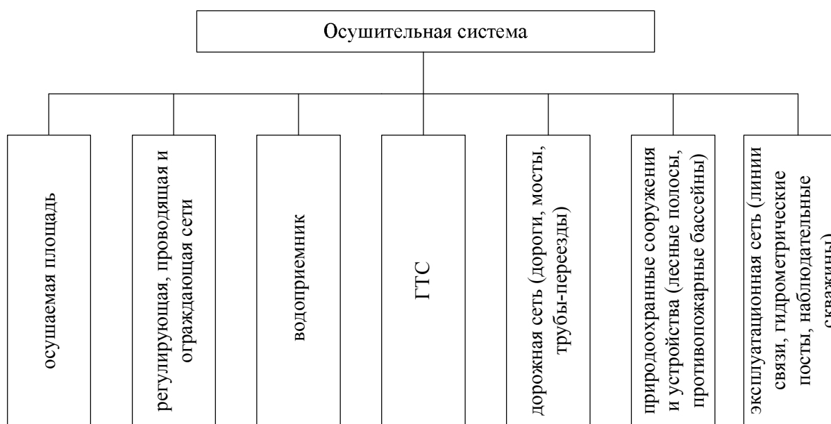
Рисунок 21 – Состав осушительной системы согласно Мелиоративной энциклопедии
