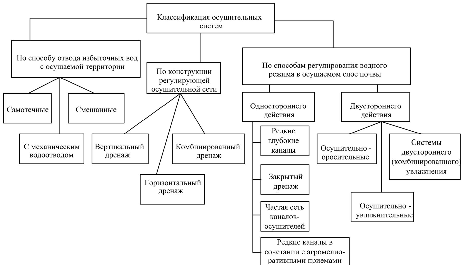
Рисунок 29 – Классификация осушительной системы согласно П. А. Волковскому
