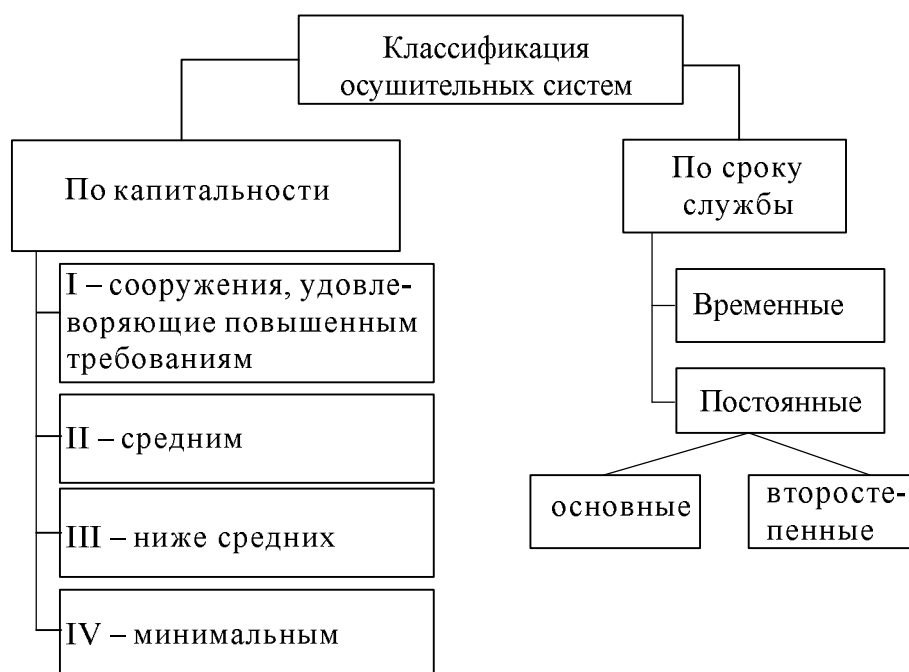
Рисунок 36 – Классификация осушительных систем согласно М. Н. Грацианскому
