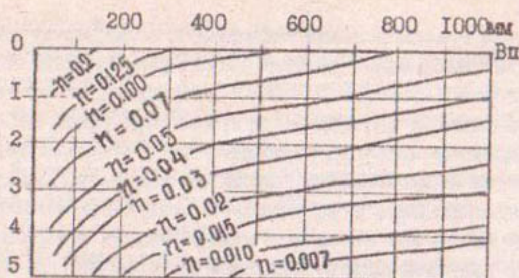
Рис. 1. Графики взаимосвязи между содержанием солей в грунтах, грунтовых водах, глубиной до уровня грунтовых вод и водопоступлением за год ( B_{п} )
