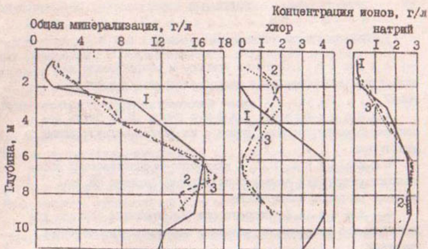
Изменение общей минерализации, концентрации ионов хлора и натрия поровых растворов на участке "Прогресс": I — богарное поле; 23.08.79 г.; поливное поле: 2—30.07.79 г., 3 — 21.04.80 г.
