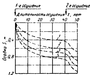
Рис. 56. Зависимость осадка торфа от длительности осушения (по Р. Эггельсманну). H — глубина торфа:
