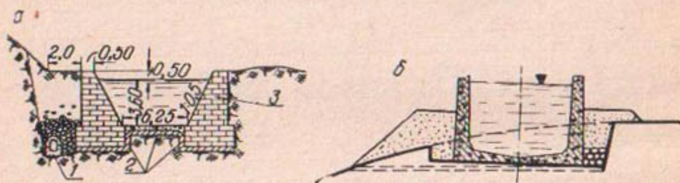
Рис. 44. Лотки на сплошных основаниях:
