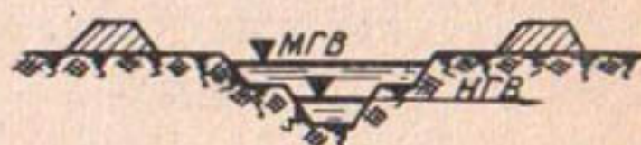
Рис. 6. Двойное поперечное сечение больших осушительных каналов.
