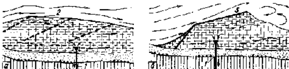
Рис. 59. Шуголедовая обстановка на р. Леонидовка у водозабора Поронайска
