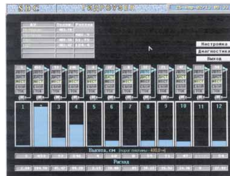
Рис.9. Экран управления гидротехническими сооружениями
