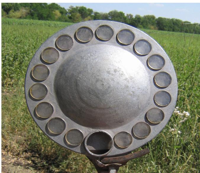
**Рис. 12. Прибор для получения отпечатков водяных капель КР-2**
