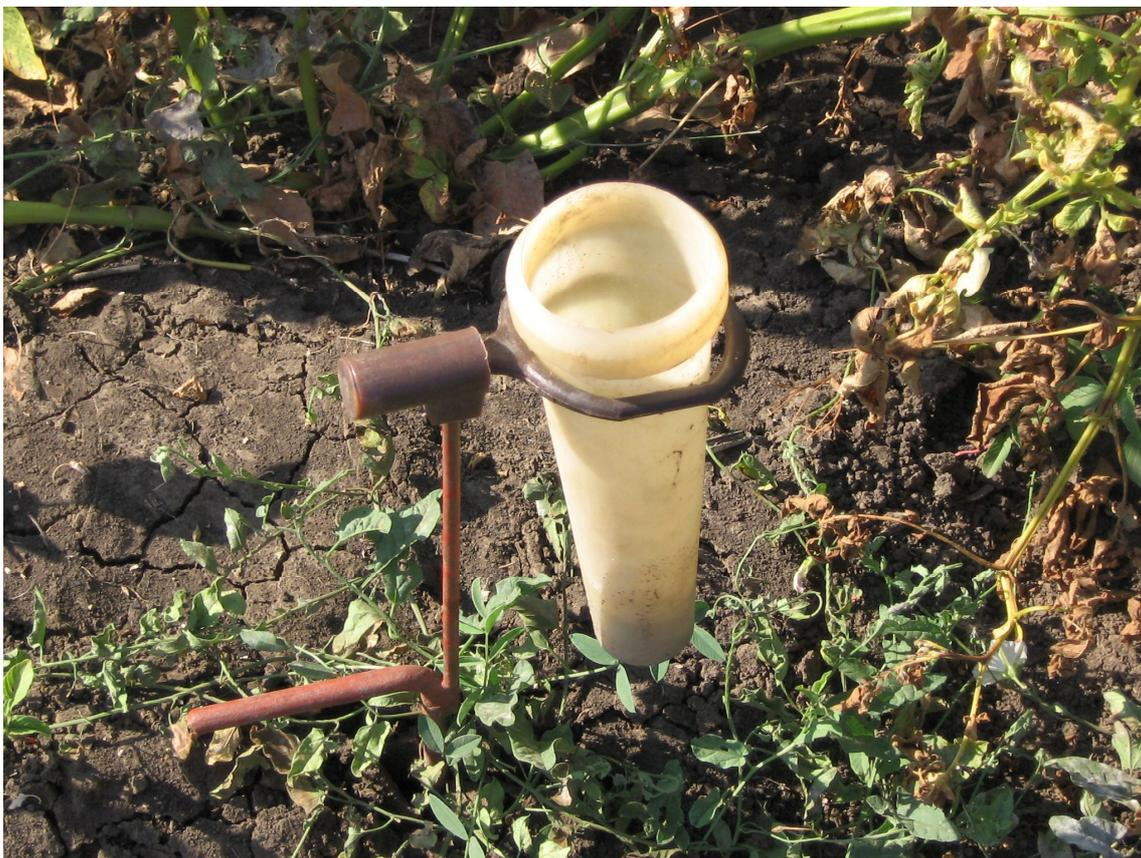
**Рис. 9. Прибор для улавливания дождевых осадков**
