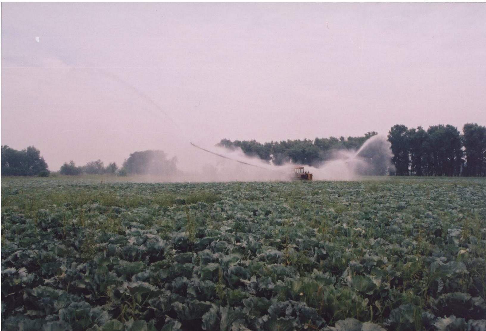
**Рис. 3. Дождевальная машина ДКДФ-1 в работе**
