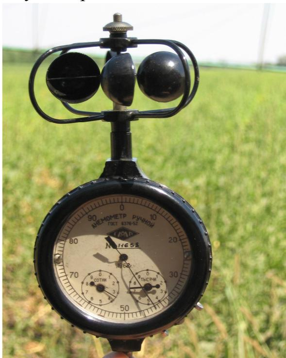
**Рис. 15. Чашечный анемометр**
