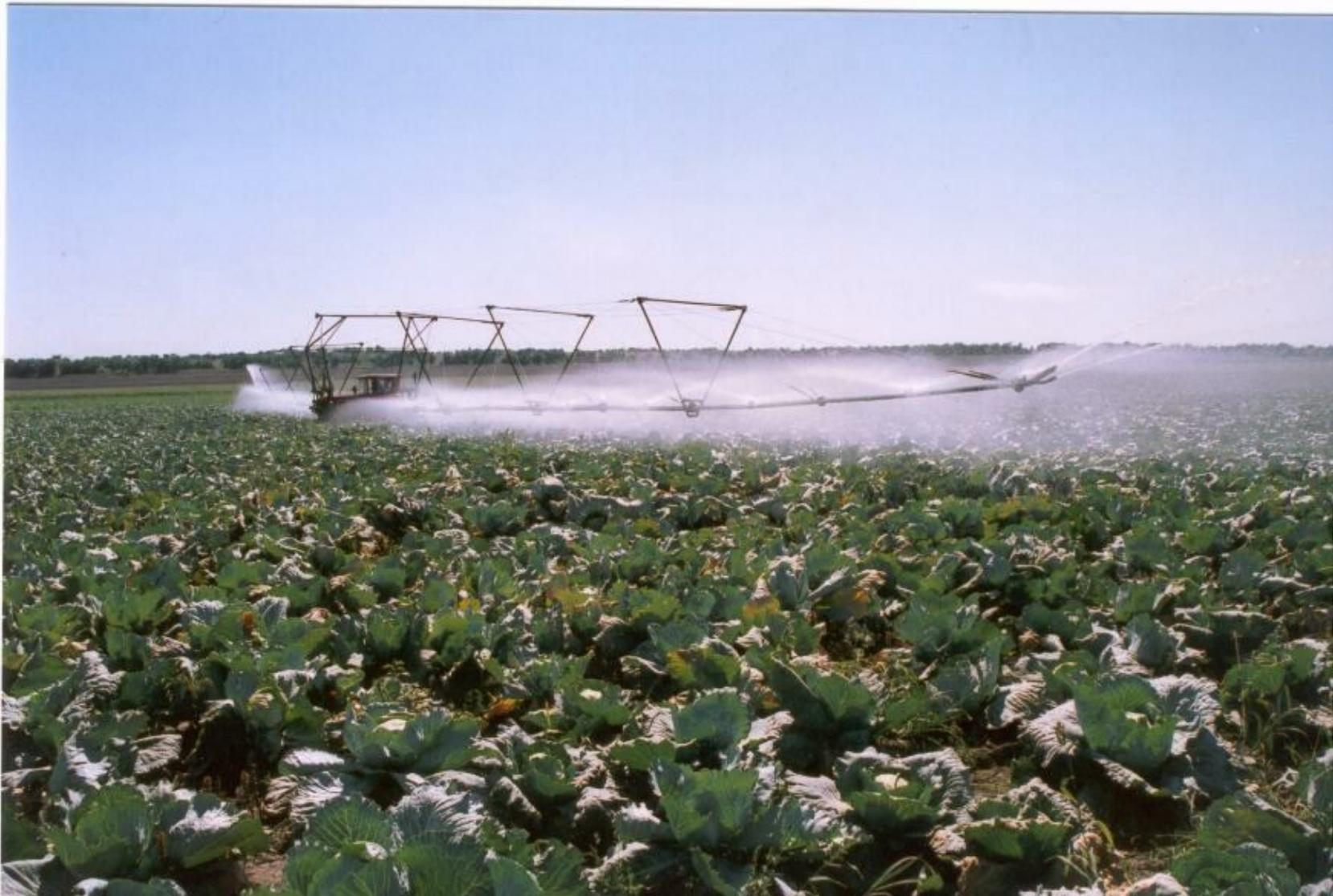
**Рис. 5. Дождевальная машина ДЖФ-1ПК**
