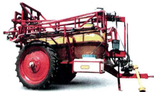
Рис. 1.68. Опрыскиватель прицепной штанговый
