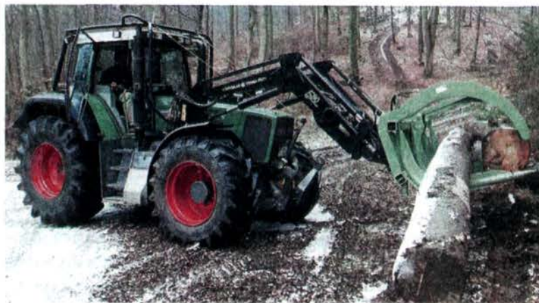
Рис. 1.44. Подборщик порубочных остатков на сборе крупномерной древесины
