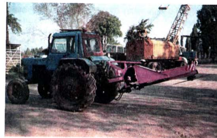
Рис. 1.32. Маятниковый кусторез на базе трактора МТЗ-80
