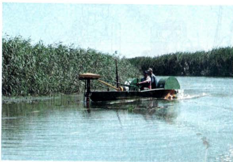
Рис. 1.22. Плавучая косилка, смонтированная на лодке
