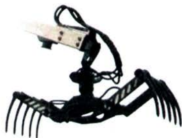
Рис. 1.55. Зубчатый грейфер сельскохозяйственного назначения
