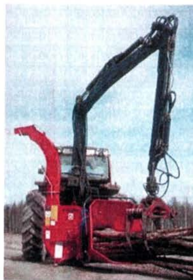
Рис. 1.60. Измельчение короткомерной древесины рубильной машиной СН260 HF-2EL
