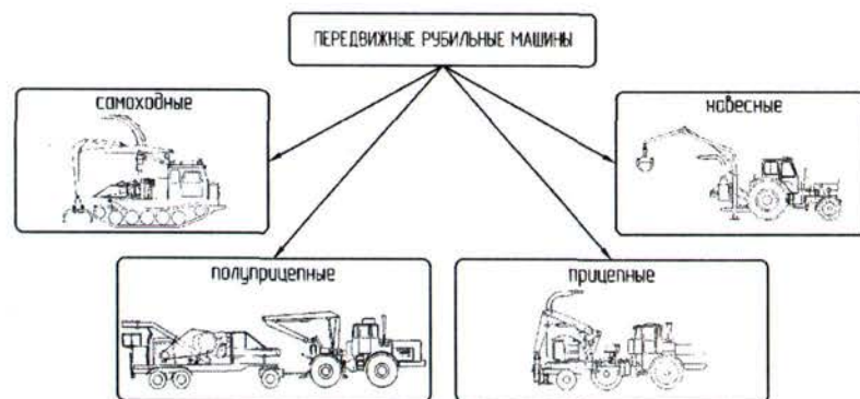
Рис. 1.59. Разделение передвижных рубильных машин по принципу агрегатирования
