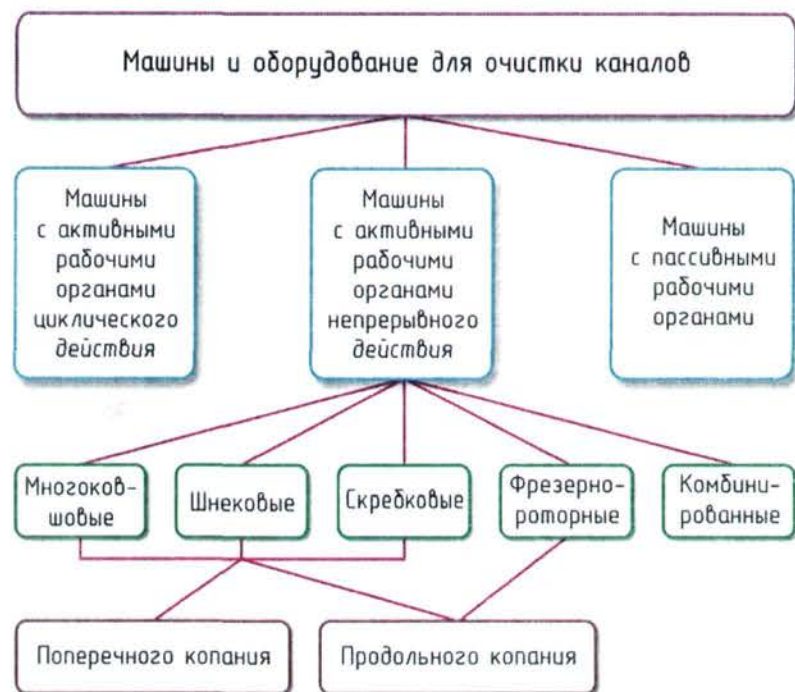
Рис. 1.71. Классификационная схема машин и механизмов для очистки мелиоративных каналов
