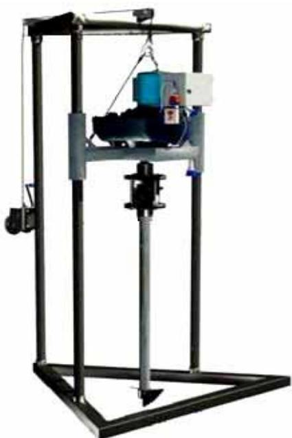
**Рис. 21. Мото-буровая установка**
