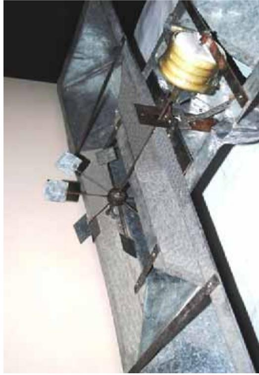
**Рис. 22.** Макет и схема водоподъёмника для дренажных вод
