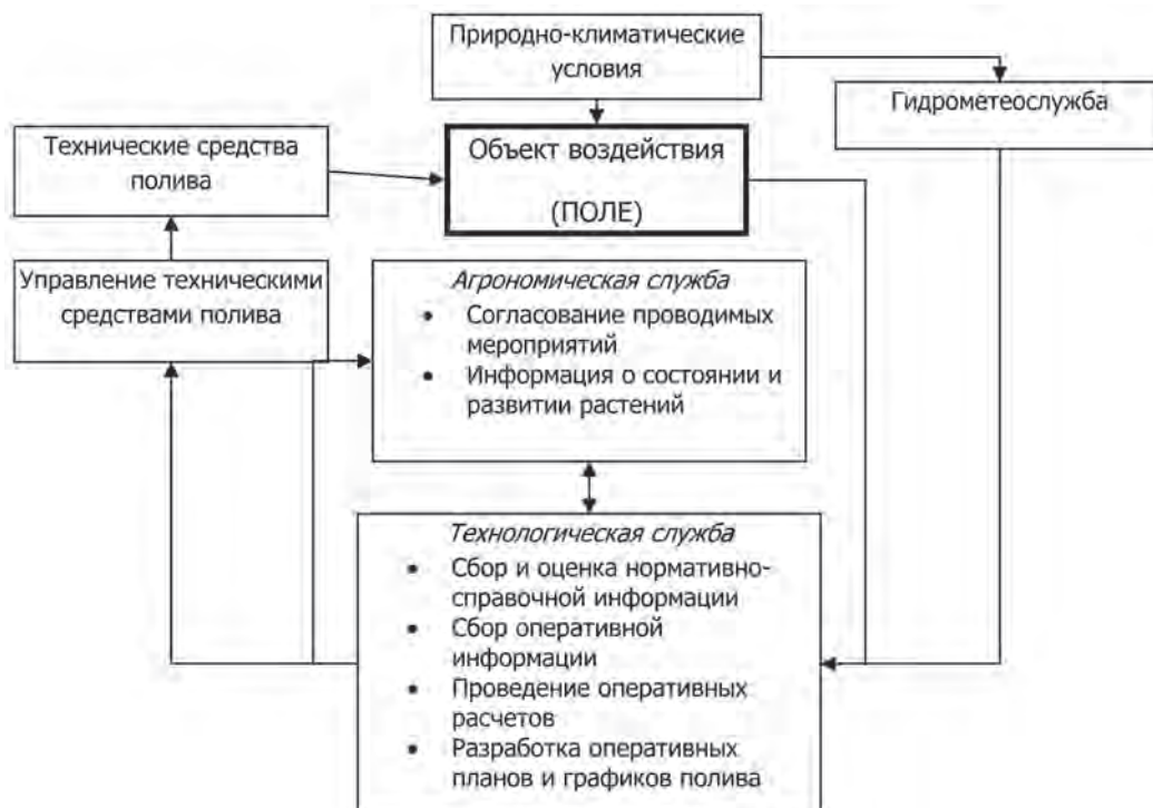
Рис.2.7. Структурно-функциональная схема оперативного управления поливами
