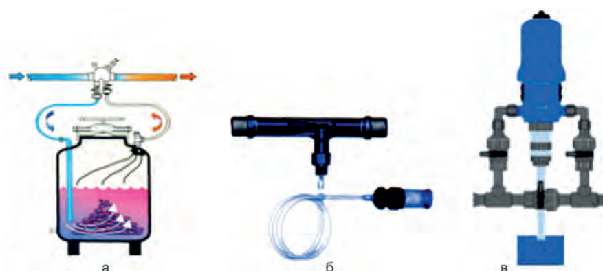
Рис. 8.8. Типы устройств для ввода растворов удобрений в поливную воду: а – емкость для растворимых удобрений; б – инжекторный насос «Вентури»; в – насос-дозатор «Дозатрон»
