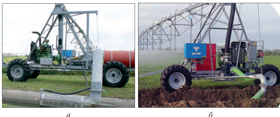
Рис. 3.1. Варианты питания ЭДМ: а – забор воды из канала; б – питание от гидрантов закрытой сети
