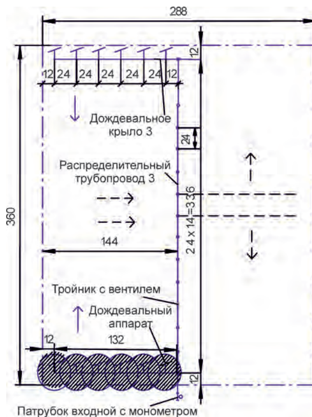
Рис. 5.3. Типовая схема орошения комплектом КИ-10 ( F_{op}=10,4 га)
