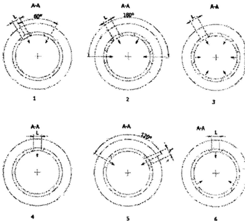
Рис. 3. Схема расположения пропилов в дренажных трубах
