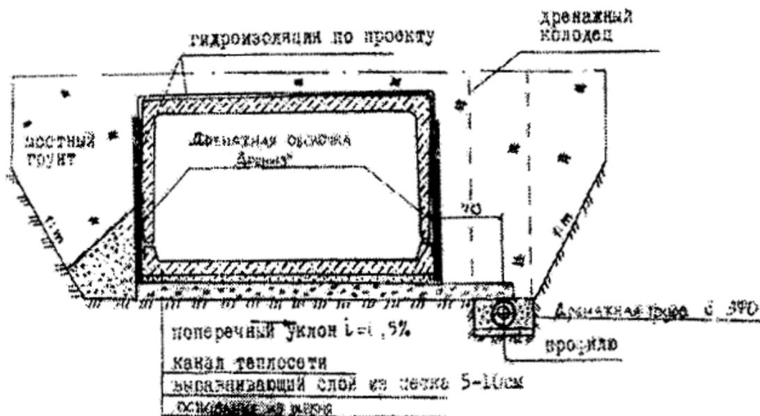
Рис. 9. Конструктивная схема сопутствующего дренажа с применением перфорированных гофрированных труб с 3ФО
