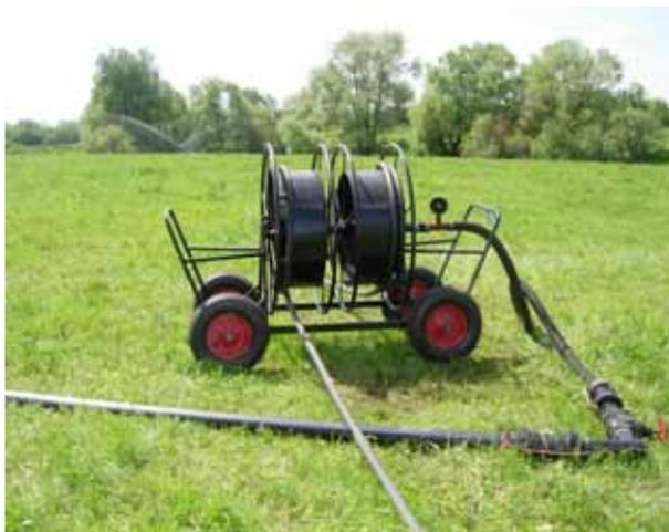
Рисунок 1 - Полосовая дождевальная установка
