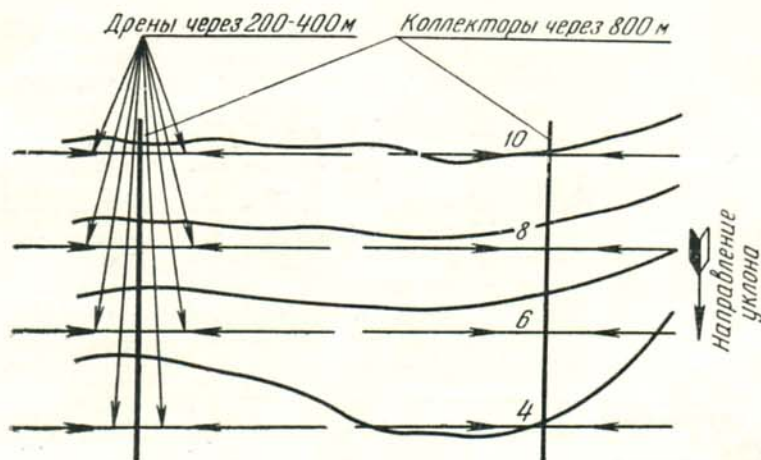
4 Поперечная схема расположения дренажной сети
