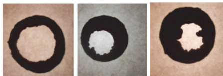
Рис. 1. Обрастание трубопроводов d = 40 мм различных лет эксплуатации
