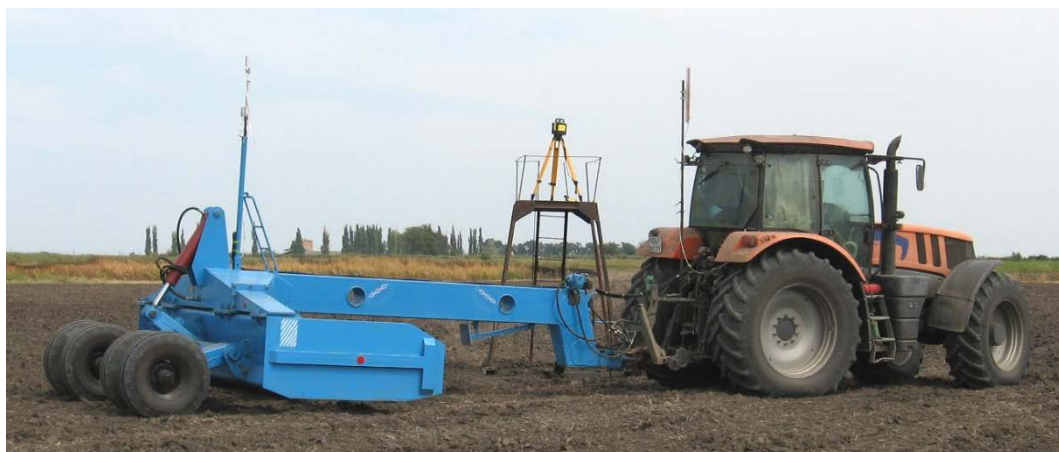
Рисунок 1 – Планировщик ПАУ-4,2Р с приемником устройства ОКО-30, лазерный передатчик Rugby-810 на металлическом посту, приемник автонивелира АН-3 на тракторе Terrion Atm 5280
