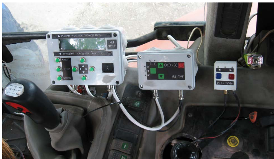
Рисунок 4 – Совмещение в кабине трактора пультов управления, слева направо: автонавигатора АН-3, лазерно-приемного устройства ОКО-30, курсового навигатора КН-1 и актуатора АК-1
